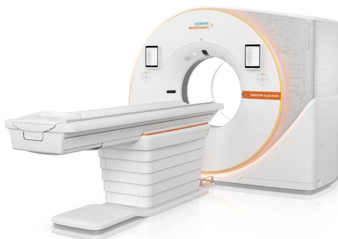
Figur 1. Fotontellende CT-maskin (Siemens Naeotom alpha.peak). I forgrunnen ser vi bordet som pasienten ligger på under undersøkelsen. Bordet føres inn gjennom den sirkulære åpningen der røntgenrør og detektorer er plassert. Bildet er gjengitt med tillatelse fra Siemens Healthineers.
